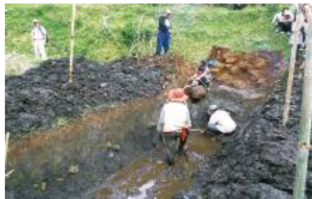
バンドン近郊におけるレンバン断層調査。背後の断層崖基部にトレンチを掘削した。地層の調査から、数千年前に地震が発生したことが明らかになった。
